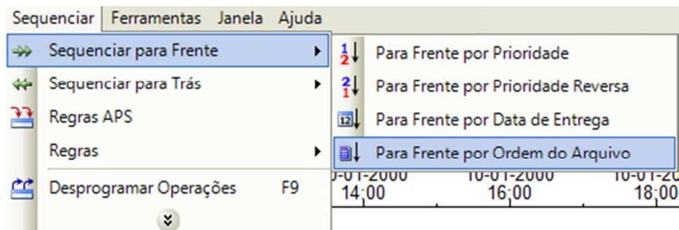
Figura 15 – Sequenciando para frente e por FIFO no *Preactor 11*
