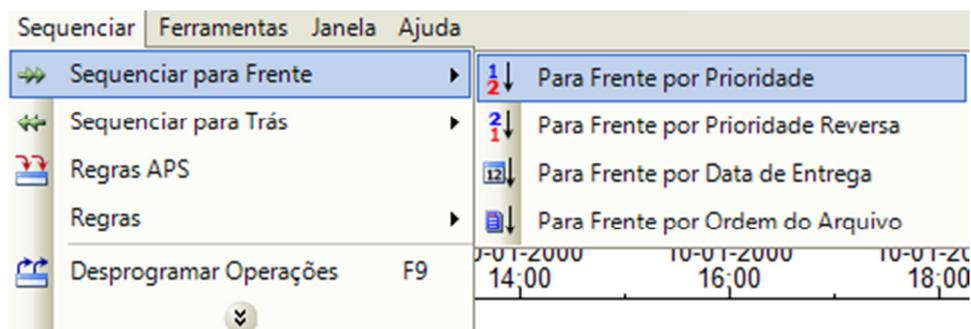
Figura 16 – Sequenciando para frente e por Prioridade no *Preactor 11*
