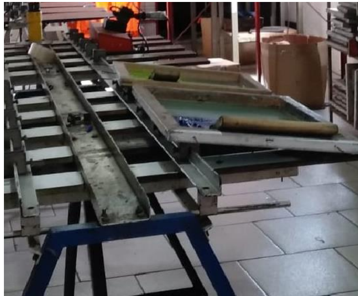
Figura 14 - Telas de serigrafia com as cores da logomarca do cliente.
