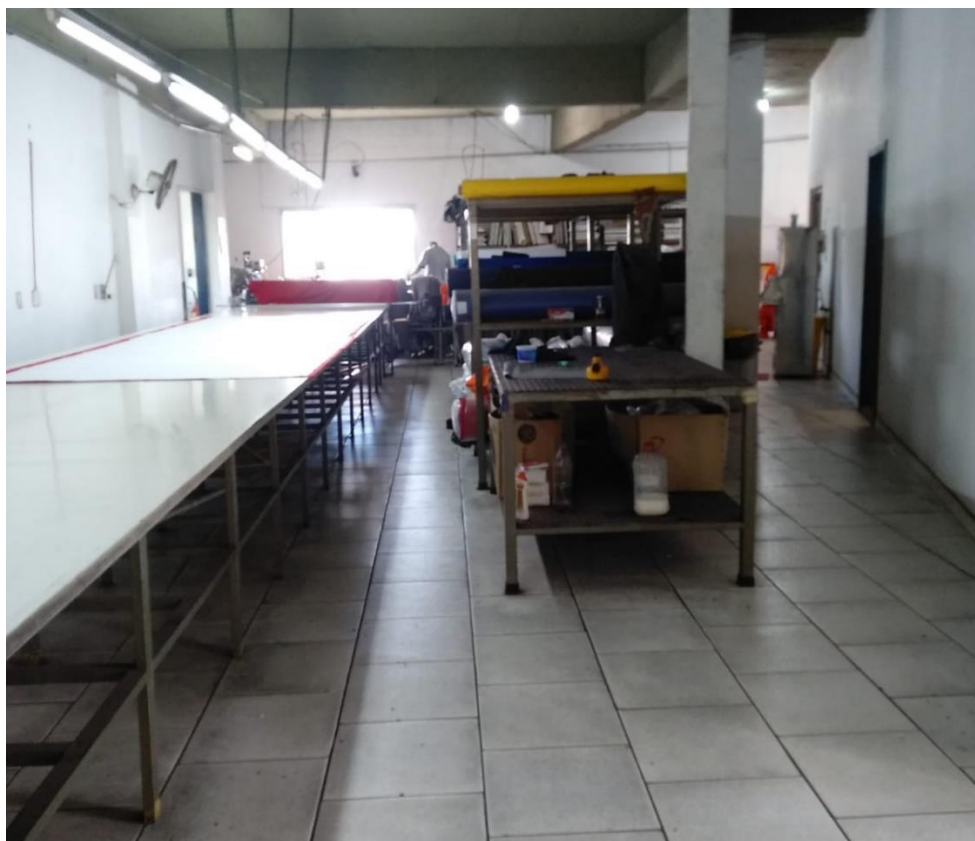
Figura 17 - Mau posicionamento das baias de tecido no setor.
